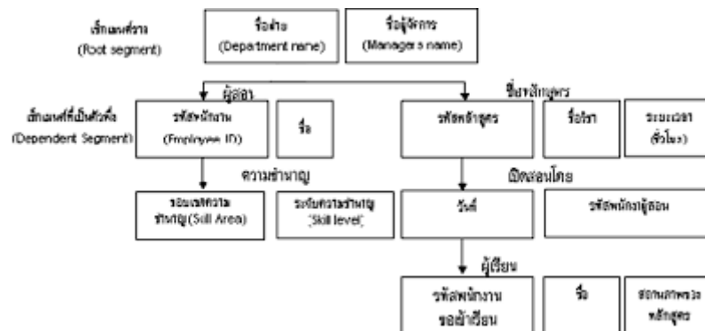
ภาพที่ 2.14 ตัวอย่างตารางฐานข้อมูลแบบลำดับชั้น (Hierarchical Database)
